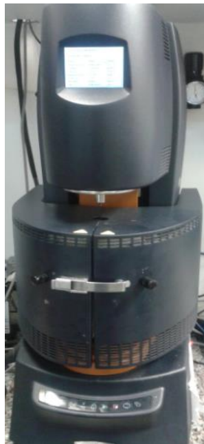
Figura 21. Imagem do Reômetro com o acessório cone-placa
