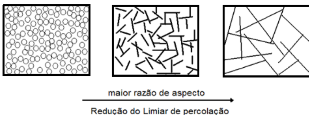
Figura 3 - Esquema ilustrativo do efeito da razão de aspecto na formação de caminhos condutores e redução do limiar de percolação.
